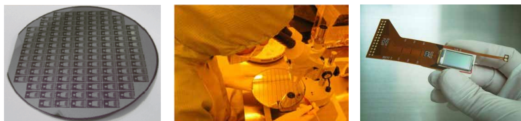
液晶空间光调制器的制备 (左)、检验 (中)、成品 (右)
