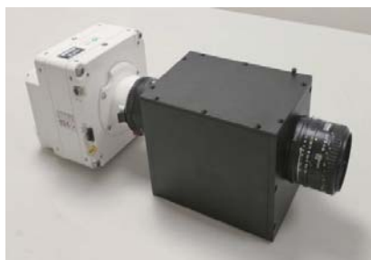
高速 ICCD 实例 (配合 Phantom 高速相机 VEO710L)
