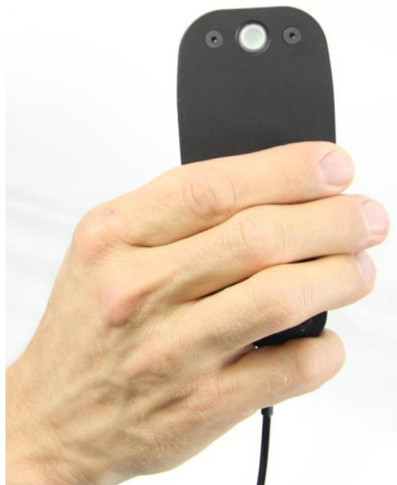
要进行测量，按下启动/暂停按钮，将 LabFlicker 移向你想测量的灯，传感器对着灯。
