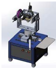
图 1 VR 延迟测试方案图
