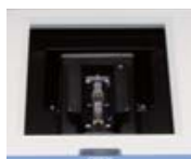
②將微量可拋式Cell安裝至主體後開始量測
