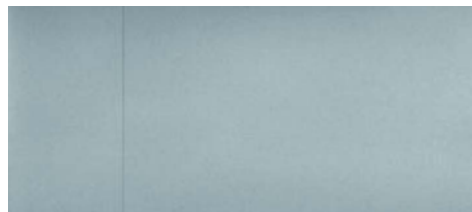
图 2. 存在可视行缺陷的显示屏屏幕的光学测量
