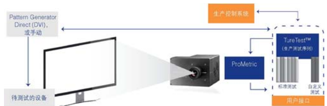
图 1. FPD AOI 测试设置，影像亮度色度计处在自动软件控制下
