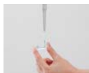
①用吸液管吸取樣本至微量可拋式Cell
